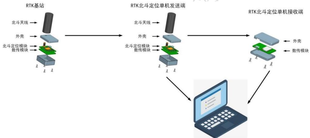
图 3 RTK 高精度定位模块编程连接关系
